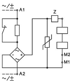
wechselstrombetätigt mit Gleichstromspule
