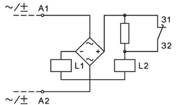
wechsel- und gleichstrombetätigt mit Sparwiderstand
