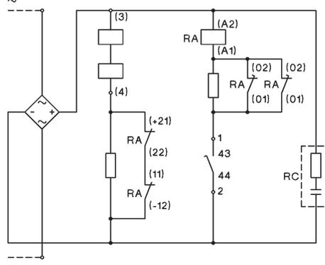
gleichstrombetätigt mit Gleichstromspule
