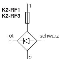
Die im Schaltbild angegebenen Farben beziehen sich auf die vom Gerät abgehenden Anschlußleitungen.
