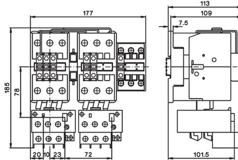
Polumschalterschütze, stahlblechgekapselt, Schutzart IP54
