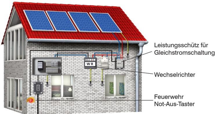
In vielen Photovoltaik-Anlagen befindet sich der in der Norm IEC 60364-7-712 geforderte Lasttrennschalter im Wechselrichter. Dadurch stehen auch nach Freischaltung die Leitungen zwischen Solarmodulen und Wechselrichter unter Spannung.
