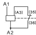
wechsel- und gleichstrombetätigt mit Sparwiderstand
