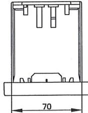
Montage mit Klemmbügel mit Schrauben
