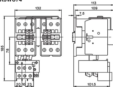
Wendeschtzue stahlblechgekapselt, Schutzart IP54
