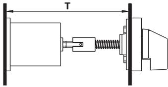
Für Schalter, welche in Schaltschränke oder Verteiler mit schwenkbaren Türen eingebaut werden, stehen Türkupplungen zur Verfügung, welche das Öffnen der Türen gestatten, ohne daß die Schaltergriffe abmontiert werden müssen.
