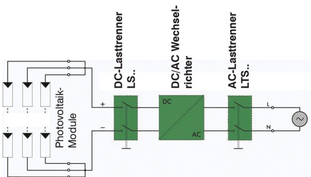
Lasttrennschalter „LS“ gewährleisten ein zuverlässiges Schalten von bis zu 85A bei 1500V in der Kategorie DC21B (DC-PV1).
