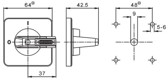
**Sperrvorrichtung SV3** (für 3 Vorhängeschlösser mit Bügel  $\varnothing$  8mm)
