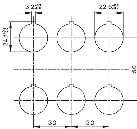
Die angegebenen Maße sind Mindestmaße. (Einbauraster nach IEC). Bei Rüsselgriffen ist ein Schwenkbereich von 27mm und bei Pilztastern der Durchmesser des Pilzknopfes zu berücksichtigen.
