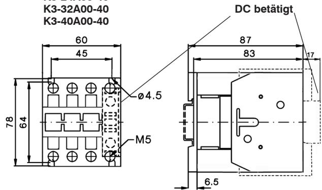
Schütze 4-polig, wechselstrombetätigt / gleichstrombetätigt
