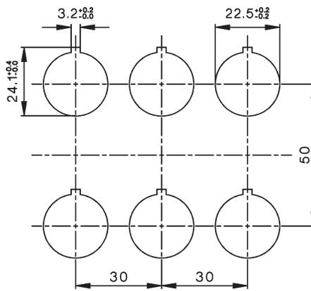
Die angegebenen Maße sind Mindestmaße. (Einbaustarter nach IEC). Bei Rüsselgriffen ist ein Schwenkbereich von 27mm und bei Pilztastern der Durchmesser des Pilzknopfes zu berücksichtigen.
