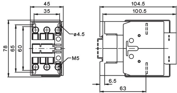
Schütze 4-polig, wechselstrombetätigt / gleichstrombetätigt
