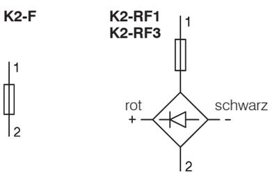
Die im Schaltbild angegebenen Farben beziehen sich auf die vom Gerät abgehenden Anschlußleitungen.
