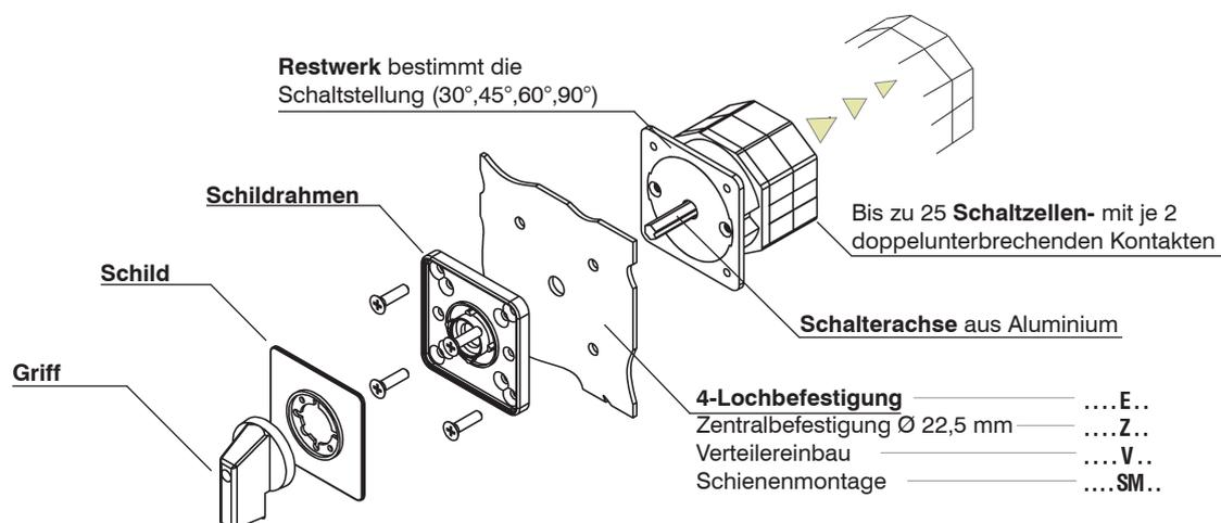
1) Steuerschalter mit Doppelkontakten und erhöhter Kontaktsicherheit.
