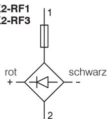
Die im Schaltbild angegebenen Farben beziehen sich auf die vom Gerät abgehenden Anschlußleitungen.
