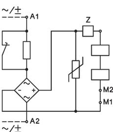
wechselstrombetätigt mit Gleichstromspule
